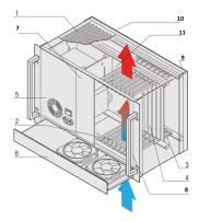
Sistema CompactPCI de 7 U con jaula de tarjeta vertical para ocho placas de 6 U, ocho placas RTM y fuente de alimentación ATX incorporada.
