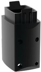
El adaptador de tubo Syspend 281-Max se acopla al tubo con conjuntos internos y proporciona orificios de montaje en el extremo donde se cortó el tubo. Use el adaptador de tubo cuando el tubo esté cortado hasta el largo adecuado y no se recomienda perforar y golpear nuevos orificios en el tubo. Solo instale el adaptador de tubo en el lado de la carcasa.
