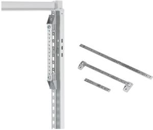
Están disponibles tres tamaños de barras de tierra y así como soportes de montaje aislados. Las barras incluyen orificios roscados M6 y M5 para proporcionar un punto común para el equipo de conexión a tierra. Se adapta a todos los gabinetes si se monta verticalmente. Consulte la tabla para montaje horizontal.
