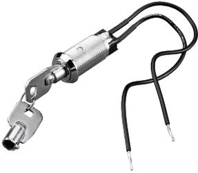
Permite que el personal autorizado entre en un gabinete mientras el contenido del gabinete está energizado. El anulador es un interruptor de contacto momentáneo accionado por llave con contactos normalmente cerrados. Al girar la llave, el circuito desacopla el interbloqueo eléctrico.
