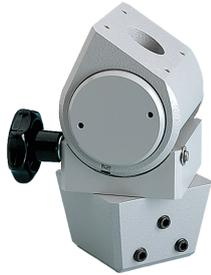
La inclinación giratoria Compact Series 4 se monta entre un tubo vertical y el gabinete para brindar opciones de giro e inclinación para el operador de la máquina. El giro permite una rotación máxima de 300°. Apertura central para cables de control. La perilla de inclinación permite un ajuste de inclinación infinito desde la posición horizontal hasta 30°. La carga máxima para las aplicaciones aéreas es de 110 lb (50 kg).
