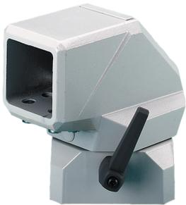
El acoplamiento de codo de brida del sistema 80 de la serie Compact 4 se conecta directamente al gabinete para aplicaciones en las que no se requiere un tubo vertical, lo que permite la rotación del gabinete de 300 grados. El gabinete se puede bloquear en su posición. Incluye una placa de acceso para una fácil instalación de cables.
