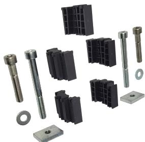
Kit de cortocircuito alto diseñado para actualizar el IFBS de nVent ERIFLEX para que pueda resistir valores de cortocircuito alto de hasta un pico de 130 kA. Este kit incluye dos tuercas de canal strut, dos M8: tornillos con cabeza CHC (75mm), dos M8: tornillos con cabeza CHC (40mm) y cinco espaciadores reforzados.
