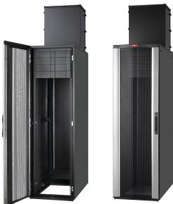
El ProLine FloTek TD mejora la eficiencia del equipo y reduce los costes energéticos dirigiendo el escape caliente desde el gabinete hacia arriba por encima de la cámara de distribución de aire o el techo y lejos del aire de la sala fría. Fotografía mostrada con paneles ciegos sin herramientas (a presión) instalados. Se piden por separado.
