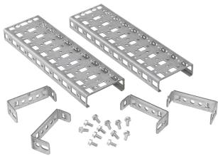
Las rejillas de montaje están provistas de orificios rectangulares especialmente diseñados para permitir el uso de tuercas enjauladas o tuercas enjauladas para carga frontal. Los orificios de montaje se proporcionan en centros de 25 mm. Las rejillas de montaje están disponibles con 1 o 3 filas de orificios y se proporcionan en pares. Se incluye el herraje de montaje para fijar las rejillas de montaje al marco o a otras rejillas de montaje.
