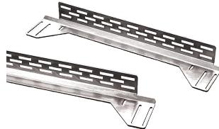
Los rieles de montaje permiten colocar los ángulos del rack en cualquier lugar dentro del marco ProLine. El ajuste de izquierda a derecha sólo se aplica cuando el gabinete es más ancho que el mínimo requerido para los ángulos de rack. Se suministran dos rieles de montaje de mano derecha y dos de mano izquierda. Se incluyen herrajes de montaje.
