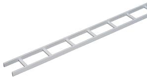
Las secciones rectas de la escalerilla soportan el cable en tramos rectos. Está hecho de acero tubular de 1-1/2 pulg. x 3/8 pulgadas (38 mm x 8 mm) de calibre 16. La longitud nominal instalada es de 10 pies (3.05 m). Cada sección mide 9 pies 11-1/2 pulg. (3.03 m) de largo con travesaños soldados a intervalos de 9 pulg. (229 mm).
