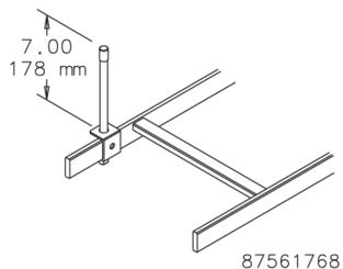
El kit de postes retenedores de la guía de cables proporciona capacidad adicional para la escalerilla. El poste retenedor se monta en el larguero lateral del rack. El poste está hecho de un tubo de 1/2 pulg. sin roscar. El kit incluye tapa de poste y herraje de montaje.
