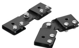
El kit de conexión de empalmes ajustable de la guía de cables permite cambiar la dirección ascendente y descendente de la guía de cables. Se puede ajustar con cualquier ángulo de 0 a 90 grados. Cada kit conecta una sección de escalerilla con otra. El kit también incluye herrajes de montaje.
