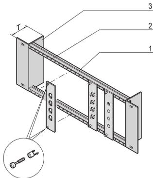
El soporte del módulo es necesario para el montaje de paneles frontales de ancho parcial con recortes SUB-D, ST tipo 3 o FDDI, con o sin riel de alivio de tensión.
