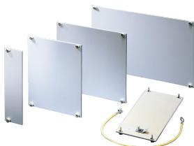
Panel frontal con conexión GND/puesta a tierra. La conexión a tierra se puede hacer con un cable que se ajusta al pasador de sujeción en la parte trasera del panel.
