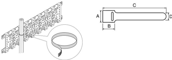
La tira de velcro® es una de las soluciones de agrupación de cables más sencillas. La tira de velcro® nVent permite cables de hasta 90 mm de diámetro.
