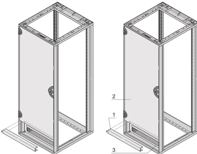
Soporte de bisagra de puerta para puertas acortadas, Heavy-Duty y Slim-Line, delantero o trasero.
