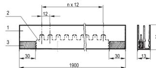
Schroff Busbar es una tira o barra metálica, normalmente alojada dentro del equipo de distribución, tableros de panel y recintos para la distribución local de energía de alta corriente.
