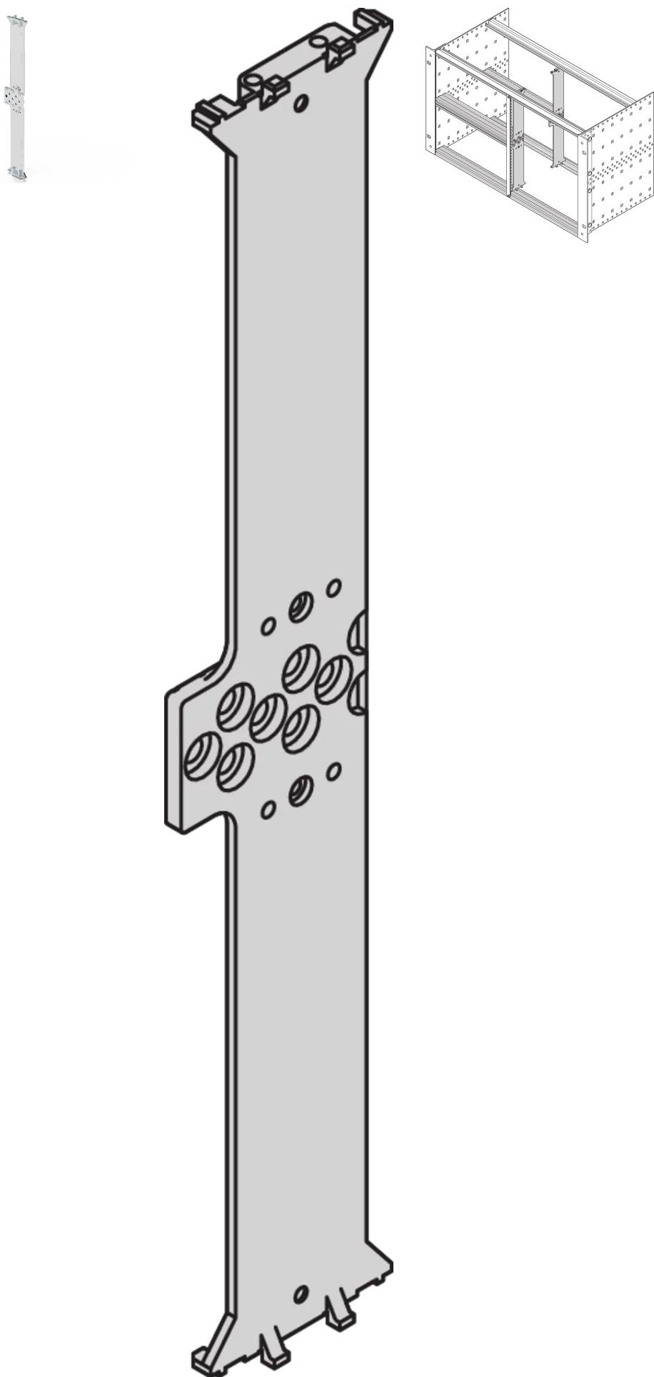
El soporte está atornillado en los orificios de la rejilla de los rieles horizontales y permite una división de un subrack de 6 U en 2 x 3 U.
