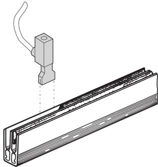
el conector de alimentación para barras de busque logra una distribución interna de energía diseñada para reducir la complejidad del servidor y proporcionar una conexión separable que facilita el montaje, la inspección y la resolución de problemas.
