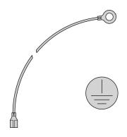
Protective GND/earthing connections in accordance with: DIN EN 50178, VDE 0160DIN EN 62368-1, VDE 0805 DIN EN 61010-1, VDE 0411 Part 1 DIN EN 61010-1A2, VDE 0411 Part 1/A1.
