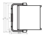
Aufstellgriff für RatiopacPRO/-AIR mit einer statischen Tragkraft von 30 kg und ohne mechanisches Bearbeitung am Gehäuse nachrüstbar.
