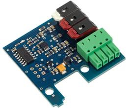
nVent RAYCHEM Raystat-V5 Plugin ist ein Sensormodul zum Austauschen alter Steuerungen ohne Abisolieren und Sensoraustausch.
