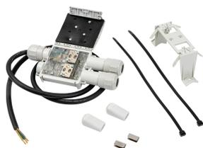
Das nVent RAYCHEM RayClic-Verbindungssystem ist ein einfacher, schneller und zuverlässiger Satz von Verbindungsgarnituren, die für eine Auswahl von selbstregelnden nVent RAYCHEM XL-Trace-, IceStop- und HWAT-Heizbändern entwickelt wurden. Es sind keine Heißluftpistolen oder Abisolierarbeiten erforderlich, da für die elektrische Verbindung eine Schneidklemmtechnik verwendet wird.
