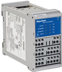
nVent RAYCHEM NGC-40-Serie – E/A-Modul bietet bis zu vier zusätzliche RTD-Eingänge. Diese können jedem NGC-40-HTC/HTC3-Modul zugewiesen werden. Es bietet außerdem ein Alarmrelais, das an einen externen Melder angeschlossen werden kann, und einen programmierbaren Digitaleingang, der einem beliebigen NGC-40-HTC/HTC3-Modul für verschiedene Funktionen wie das Ein- oder Ausschalten des Schützes oder des SSR zugewiesen werden kann.
