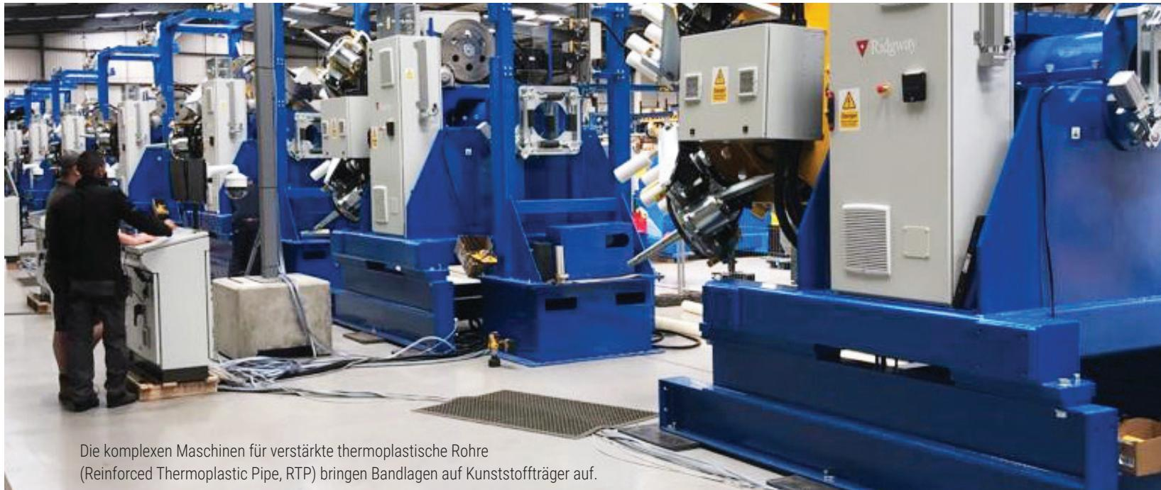
Die komplexen Maschinen für verstärkte thermoplastische Rohre (Reinforced Thermoplastic Pipe, RTP) bringen Bandlagen auf Kunststoffträger auf.
