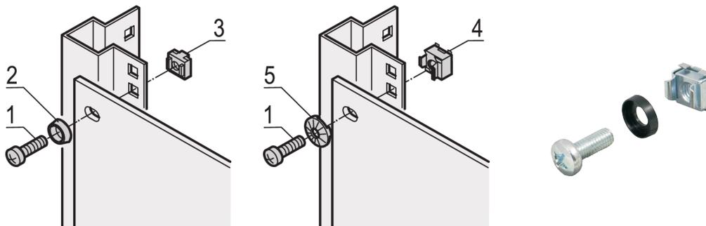
Verwenden Sie für die Standarderdung eine Erdungsmutter und eine Unterlegscheibe an mindestens einem Befestigungspunkt.
