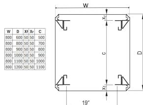
Der geschweißte Varistar CP-Rahmen ist für statische Lastanforderungen verfügbar und kann mit 19", ETSI oder Montageplatte integriert werden. Zusätzlich kann der Rahmen bei Bedarf mit Lenkrollen ausgestattet werden.
