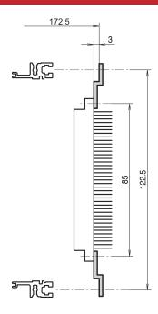
Z-Schiene für Steckerbinder nach DIN 41617, 31-polig.
