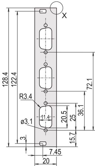
Flache Frontplatte mit Ausbruch für D-Sub-Steckverbinder.
