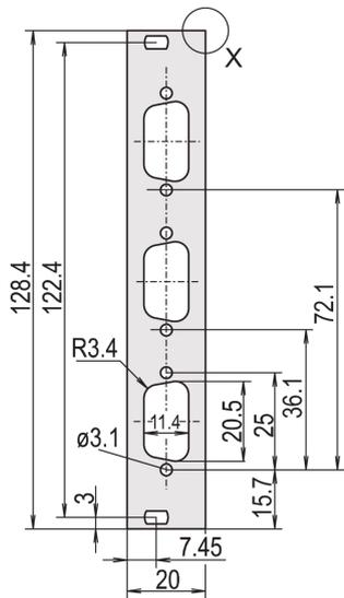
Flache Frontplatte mit Ausbruch für D-Sub-Steckverbinder.
