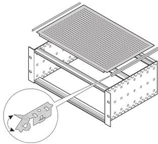
Eine Abdeckplatte wird zur elektromagnetischen Abschirmung oder als mechanischer Schutz verwendet. Die Abdeckung kann verwendet werden, wenn nicht standardisierte Boards in den Baugruppenträger eingebaut werden.
