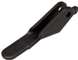
Die Serie 71 bietet Unterstützung bei der Extraktion von Leiterplatten mit Steckverbindern mit hoher Kontaktdichte oder mehrfachen Steckverbinder-Anwendungen. Mit einem Übersetzungsverhältnis von 4,5:1 kann die Serie 71 für Cold-Wall Anwendungen mit allen SCHROFF Card- oder Wedge-Loks verwendet werden. Bei Blechgehäusen könne die Hebel mit den PCB Tainern der Serie 24 oder 127 eingesetzt werden, jedoch nur mit der optionalen Flanschfunktion.
