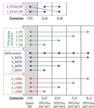
4 HE CompactPCI PlusIO System mit vertikalem Kartenkorb für einen CPCI PlusIO System Controller, 4 CompactPCI und 3 CompactPCI Serial Peripherie-Boards und ein steckbares CompactPCI 3 HE Netzteil
