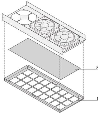
Der Luftfilter filtert die angesaugte Luft und senkt die Menge an Staub und anderen Partikeln.
