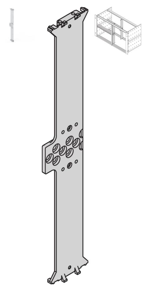
Die Strebe wird in die Rasterlochung der Modulschienen eingehängt und ermöglicht eine Teilung eines 6 HE Baugruppenträgers in 2 x 3 HE-Teile.
