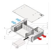
VME64x System für 4 horizontal montierte VME64x Boards 6 HE, 160 mm. Rear I/O-Option. Die Stromversorgung des Systems erfolgt über ein Open Frame Netzgerät. Ein Hot-Swap-Lüftereinschub mit 4 Lüftern garantiert hervorragende Kühlung.
