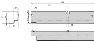
Laborgestell-Gleitschiene mit 40 kg Belastbarkeit zur Montage an den leeren Schrankholmen oder 19-Zoll Winkelprofile. Die Gleitschienen stützen den Fachboden von schweren 19-Zoll-Einschüben.
