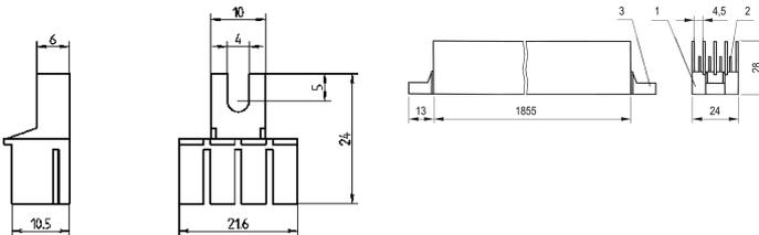
Die Stromschiene von nVent SCHROFF ist eine Metalleiste oder eine Metallschiene, die typischerweise in Schaltanlagen, Verteilertafeln oder Stromverteilergehäusen für die lokale Starkstromversorgung untergebracht ist.
