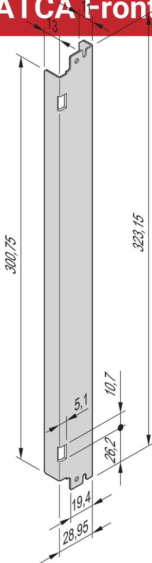
AdvancedTCA-Frontplatte für IEA-Griff mit Federkraftunterstützung mit Druckgussendstück.
