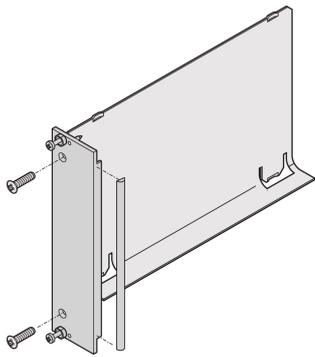
Das Luftleitblech mit U-förmiger Frontplatte deckt einen leeren Slot ab, damit keine Luft entweicht. Die U-förmige Frontplatte ist für die Befestigung einer EMV-Textildichtung vorbereitet.
