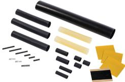
nVent RAYCHEM TE-01-CR ist ein Polymerwarmschrumpfsatz, der zum Anschließen von bis zu drei selbstregelnden nVent RAYCHEM-Begleitheizungskabeln zur Herstellung einer Verbindungsgarnitur, eines T-Abzweigs und als Endabschluss verwendet wird. Erfordert Abisolieren und eine Heißluftpistole. Jeder Satz enthält Material für entweder eine Verbindung plus Endabschluss oder einen T-Abzweig plus Endabschluss.
