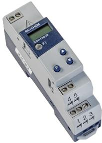
Der nVent RAYCHEM TCON-CSD/20 ist ein kompakter digitaler Oberflächenthermostat für die einfache EIN/AUS-Temperaturregelung in nicht explosionsgefährdeten Bereichen. Die Temperatur wird mit einem Fühler gemessen und auf der LCD-Anzeige ausgegeben. Der jeweilige Zustand des Ausgangsrelais wird über eine LED angezeigt.
