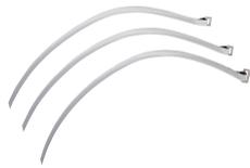
nVent RAYCHEM PBxxx-Edelstahl-Befestigungsbänder sind speziell für die Befestigung von mineralisierten (MI) Heizkabeln am Rohr konzipiert. Zangen sind das einzige Werkzeug, das zum Festziehen des Befestigungsbands erforderlich ist. Schnalle und Riemen verhindern ein Überspannen des Heizkabels und verhindern Ermüdungsfehler, die durch Expansions- und Kontraktionszyklen im Betrieb verursacht werden.
