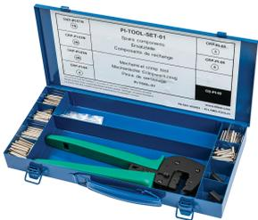
Beim nVent RAYCHEM PI-TOOL-SET-01 handelt es sich um einen Metallwerkzeugkoffer mit Hand-Crimpzange, Crimpzangeneinsätzen und Crimphülsen für die Verbindung von PI-Heizkabeln und Kaltleitern mit Verbindungs-/Verbindungssatz-Ausführung CS-150-2.5-PI (Leiterquerschnitt bis 2,5 mm<sup>2</sup>).
