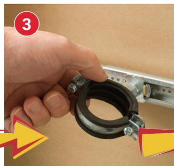
3 Rohrschelle mindestens 2,5 Umdrehungen im Uhrzeigersinn drehen; zur Einstellung des richtigen Winkels die Rohrschelle keinesfalls gegen den Uhrzeigersinn verdrehen.
