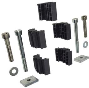
Bausatz für hohe Kurzschlussströme, um das nVent ERIFLEX IFBS so aufzurüsten, dass es hohen Kurzschlusswerten bis zu 130 kA in der Spitze standhält. Dieser Bausatz enthält zwei Strebenmuttern, zwei Innensechskantschrauben M8 (75 mm), zwei Innensechskantschrauben M8 (40 mm) und fünf verstärkte Distanzstücke.
