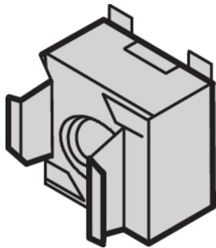
Käfigmuttern erlauben die Auswahl verschiedener Schrauben- und Muttergrößen und sind im Gegensatz zu Löchern mit vorgeschnittenen Gewinden leicht austauschbar. Die Käfigmuttern lassen sich hervorragend an dünnen oder weichen Werkstoffen verwenden, in die kein Gewinde geschnitten werden kann.
