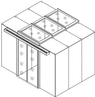
Blindplatten für unterschiedliche Einhausungshöhen verhindern das Entweichen von Luft aus dem Gang.
