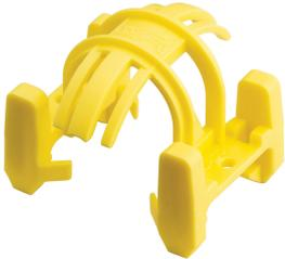
Die nVent CADDY In-Wand-Kabelrohr-Positionierklemme ist eine intuitive, werkzeug- und schraubenlose Lösung zur schnellen und sicheren Positionierung von 20 bis 25 mm-Rohren auf nVent CADDY teleskopischen Schraubpistolen-Anschlussdosenstreifen. Ideal für Trockenbauinstallationen, die stattfinden, bevor die Elektriker vor Ort sind, um Elektrodosen zu verdrahten – allgemein bekannt als „Hockeyschläger“-Installationen.
